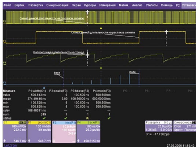
Рис. 8. Графическое отображение ШИМ сигнала и измеренных временных параметров
